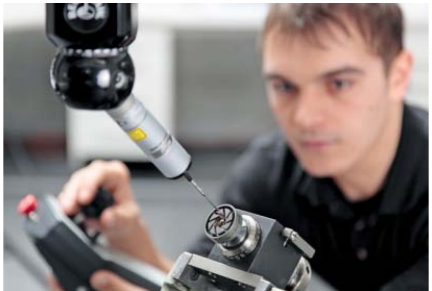
Feinjustierung im Werk Schwendi: Zusammenspiel von elektronischer Messtechnik und Augenmaß – hier bei der Vermessung einer Wirbelplatte für die Ölzerstäubung.
