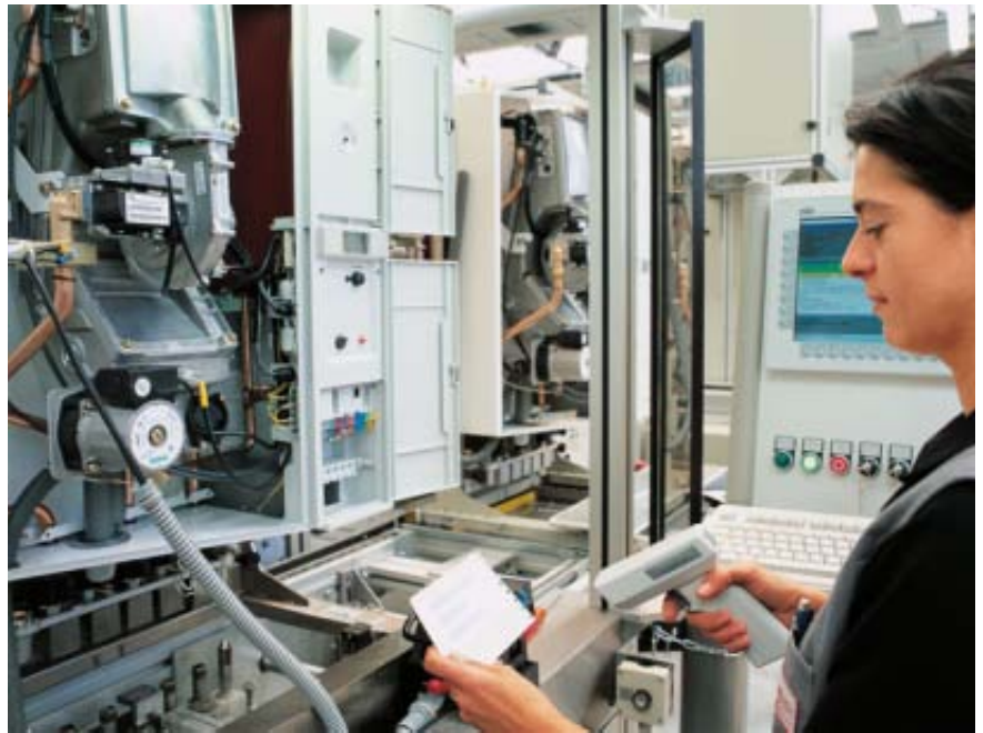
Test bestanden: Eine Mitarbeiterin quittiert den erfolgreichen Test des Gas-Brennwertgerätes (WTC-GW).
